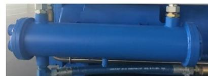
Масляный фильтр Элемент фильтра из стекловолокна, точность фильтрации 3мкм.
