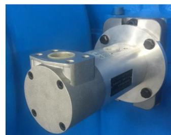
Вспомогательный масляный насос Электрический, соединен с модулем старт/стоп.
