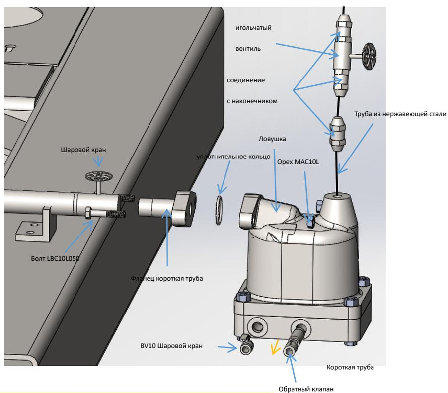
Направление потока обратного клапана показано желтой стрелкой
